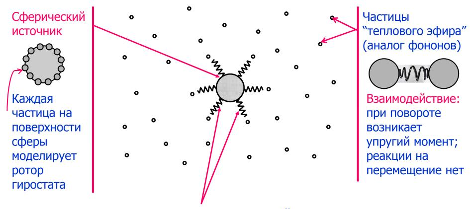
Частицы сферического источника взаимодействуют с частицами "теплового эфира" посредством упругих моментов, возникающих при относительном повороте; реакции на относительное перемещение нет
