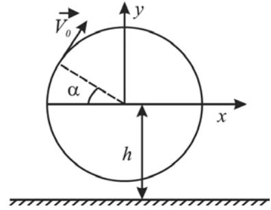
Это позволяет из закона движения тела, брошенного под углом к горизонту  $y = l \sin \alpha + V_0 \cos \alpha t - \frac{gt^2}{2}$ ,  $V_y = V_0 \cos \alpha - gt$ , определить максимальную координату  $H$ , вылетевшего из лопасти наконечника:
