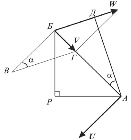
Рассмотрим движение сухогруза в системе отсчета, связанной с катером. Скорость относительного движения сухогруза  $\vec{W}$  определяется из векторного закона сложения скоростей  $\vec{W} = \vec{V} - \vec{U}$ . Тогда искомое расстояние равно длине отрезка  $AD$ . Так как в треугольнике  $ABD$  угол  $DAB$  равен  $\alpha$ , то  $AD = BA \cos \alpha$ .
