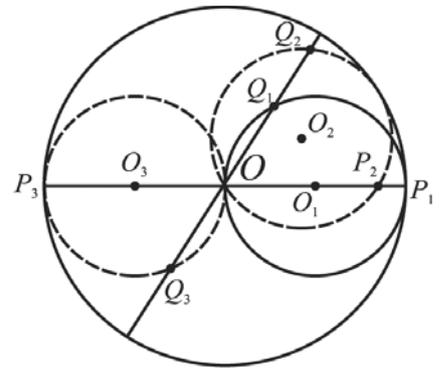
Это проиллюстрировано на рисунке. Здесь показаны три последовательных положения центра подвижной окружности:  $O_1$ ,  $O_2$  и  $O_3$ . Зафиксированная на этой окружности точка  $P$  в процессе качения меньшей окружности по окружности с центром в точке  $O$  занимает соответственно положения  $P_1$ ,  $P_2$  и  $P_3$  на диаметре. А точка  $Q$ , зафиксированная на подвижной окружности, будет двигаться по другому диаметру: ее соответствующие положения  $Q_1$ ,  $Q_2$  и  $Q_3$ .
