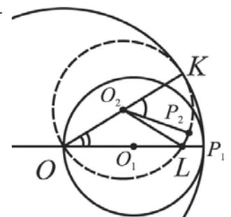
В силу отсутствия проскальзывания дуги  $KP_1$  и  $KP_2$  равны по длине. Поэтому, так как радиусы окружностей отличаются вдвое, то  $\angle KO_2P_2 = 2\angle KOP_1$ .
